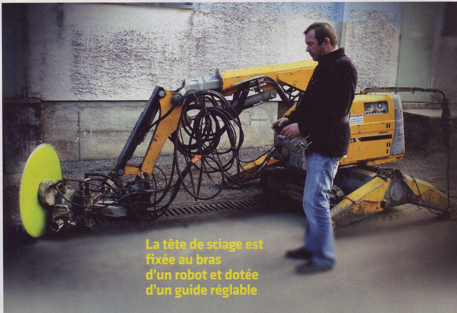
La tête de sciage est fixée au bras d'un robot et dotée d'un guide réglable
