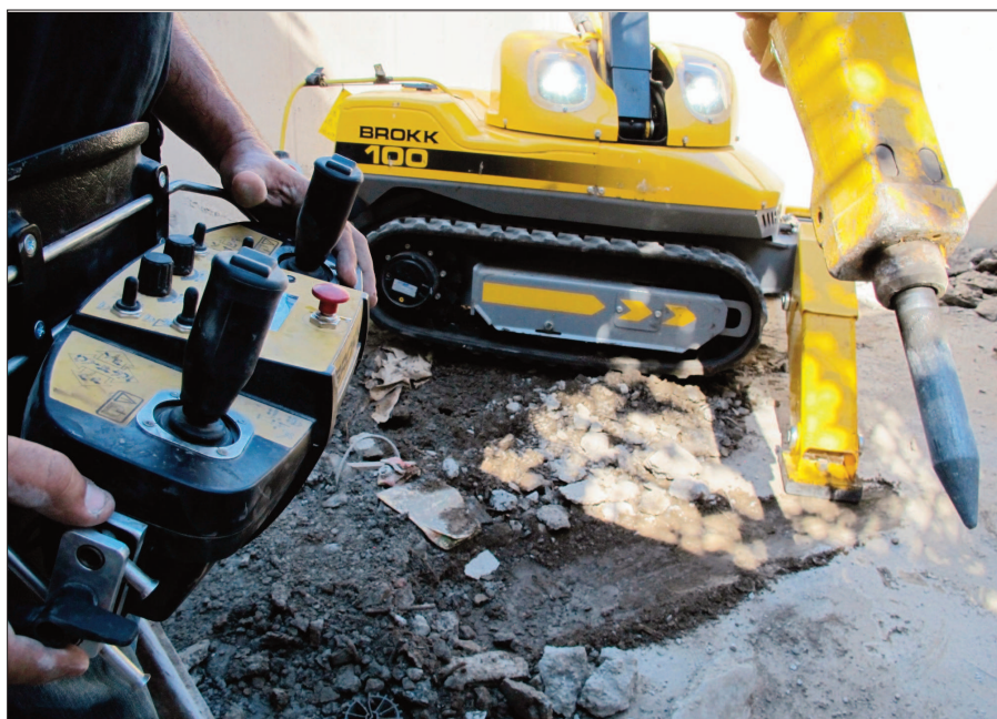
Le Brokk 100 est télécommandé via un boîtier doté de deux joysticks et de multiples boutons de commande.
